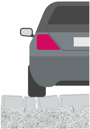
3. ábra: Túl vastag ágyazat miatt deformálódott burkolat.
